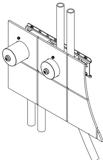
01 - Taladre los agujeros en el revestimiento, para el mezclador (verifique en la figura "B"). Diámetro del mezclador: Max. 50 mm.
