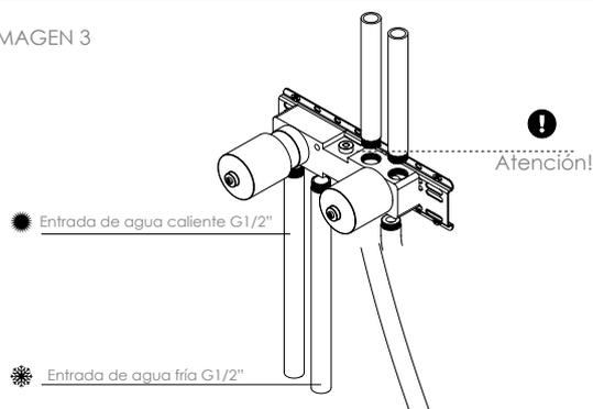
01 - Confirme con el nivel (incluido en el asiento del mezclador) que la pieza esté nivelada con el suelo. Después de comprobar que la alineación es correcta, concluya el apriete de los tornillos.
