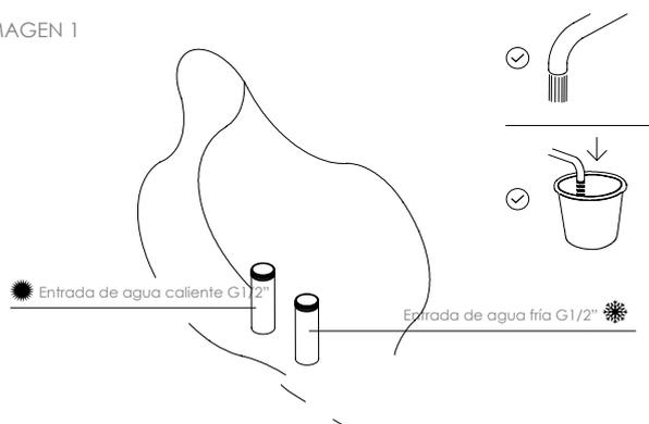
**Atención.** Antes de iniciar la instalación, las tuberías deben limpiarse adecuadamente para eliminar cualquier suciedad que pueda causar daños permanentes en el cartucho.
