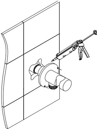
01 - Después de apretar el soporte de la ducha, aplique silicona en la parte posterior del plato y encájelo en el revestimiento.
