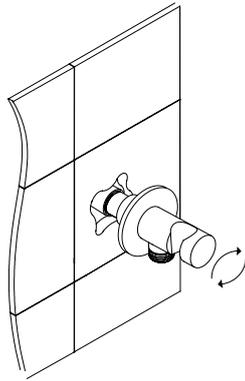
01 - Debe aislar adecuadamente la rosca G 1/2 "de la entrada de la ducha, con teflón (PTFE) o algo compatible para ese fin. Este sellado debe ser hecho con cuidado, para que no haya fuga de agua. Confirme antes de completar este procedimiento que el sellado está garantizado.
