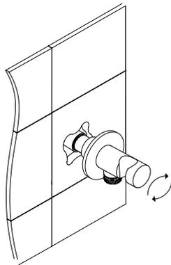
01 - Usted debe aislar adecuadamente la rosca G 1/2 "de la entrada de la ducha, con teflón (PTFE) o algo compatible para ese fin.
