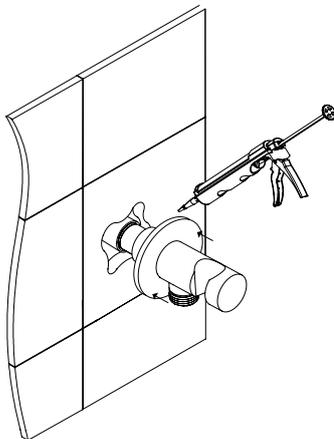
01 - Después de apretar el soporte de la ducha, aplique silicona en la parte posterior del plato y encájelo en el revestimiento.
